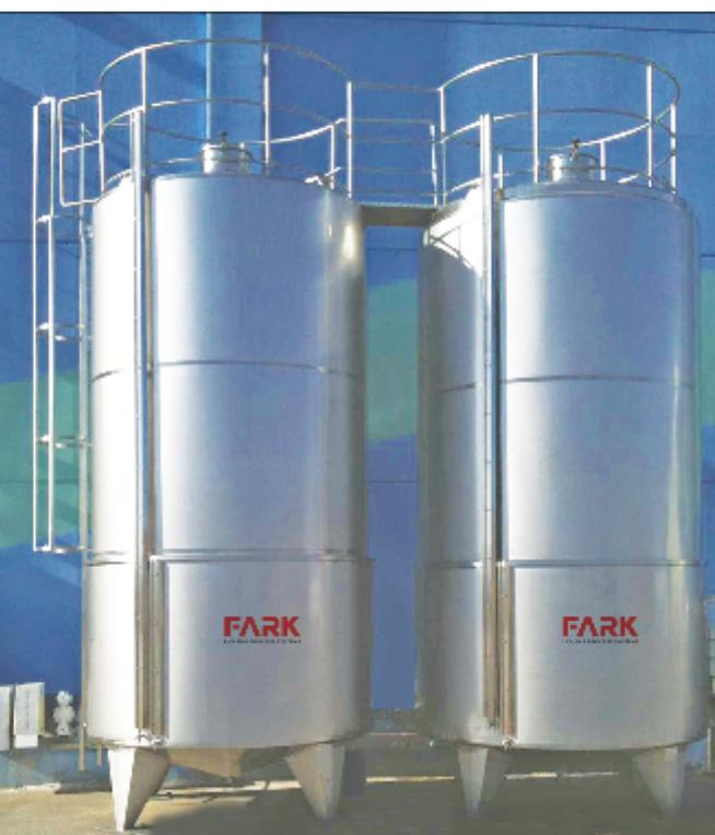
Sistem; asit tankı, kostik tankı, su tankı, ısıtma eşanjörü, pompa ve gidiş & dönüş hatlarından oluşmaktadır. Asit & Kostik tankında ürün ile temas eden yüzeyler AISI 316 kalite, diğer yüzeyler AISI 304 kalite paslanmaz çeliktir. İsteğe bağlı olarak otomasyon kontrol ünitesi, otomatik asit-alkali dezenfeksiyon ölçümü ve kontrolü sisteme dahil edilebilir. Kimyasal depolama tanklarında güvenlik amacıyla taşkan yapılmaktadır.
