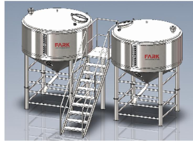
Teleme süzdürme tamburu veya çedarlama teknesinde süzülen peynir altı suyunun işlendiği proses tanklarıdır. Peynir altı suyu içerisinde bulunan serum proteinleri sıcaklık uygulaması ile birlikte denature olarak lor peyniri üretimi gerçekleştirilir. Üç cidarlı olup, rolbont ısıtma sistemlidir.
