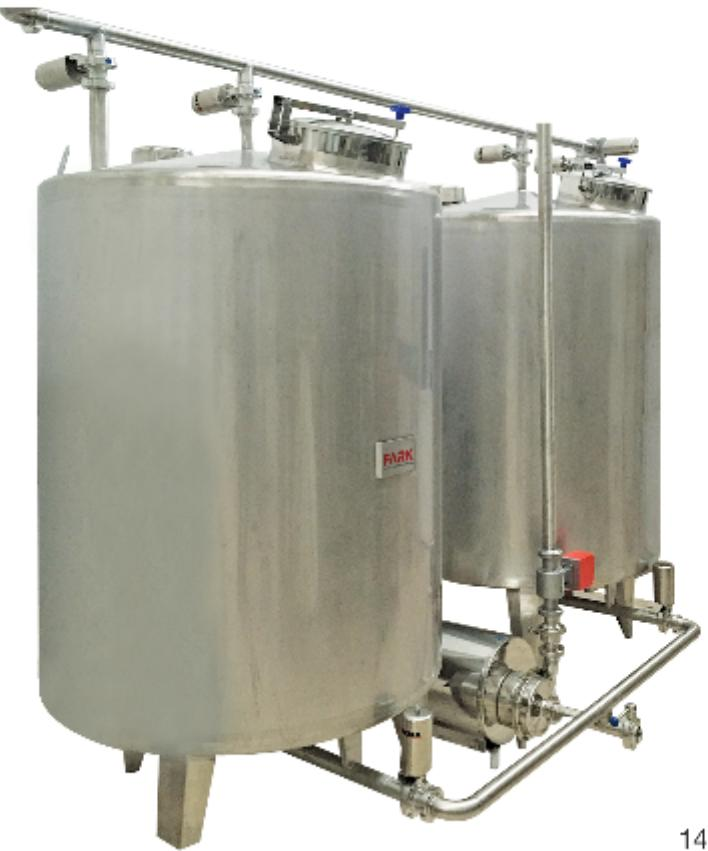
Tüm ürünlerin Pastörizasyon etkinliği ve 72°C üzerinde isıl işlem gören Yoğurt/Ayran /Beyaz peynir ürünlerinin üretiminde, etkin serum proteini denaturasyonu için Holding (Sıcakta tutma) işlemi gereklidir. Borulu tip veya tank tipi şeklinde üretilmeli好的。Tank tipi holder uygulamalarında Tam otomatik holder otomasyonu opsyonel olarak yapılabilmektedir. Borulu tip holder uygulamalarında Boru demeti şase üzerine montajlı paket tiptir.
