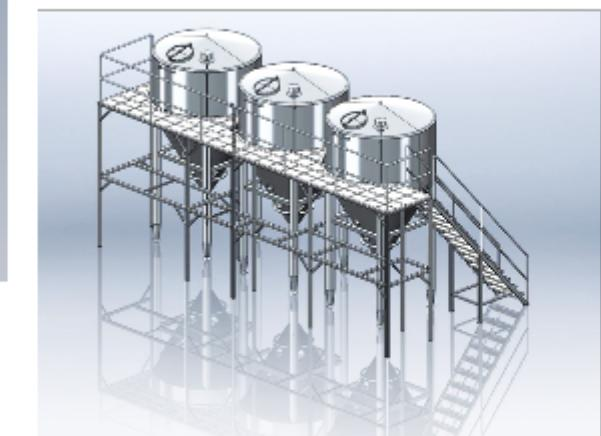
Bu sayede az buhar kullanılır ve randımanlı ürün almanızı sağlar. Alt Taban konik açısı ürün kolay boşaltılmasına göre tasarlanmıştır.
